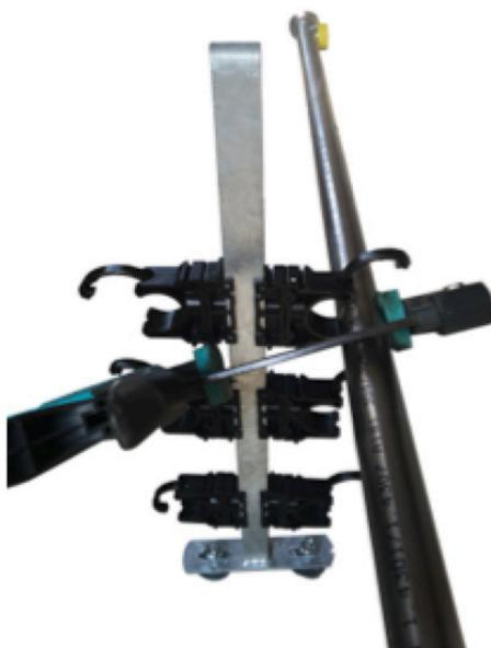
Insertion du tube à l'aide du serre-joint
