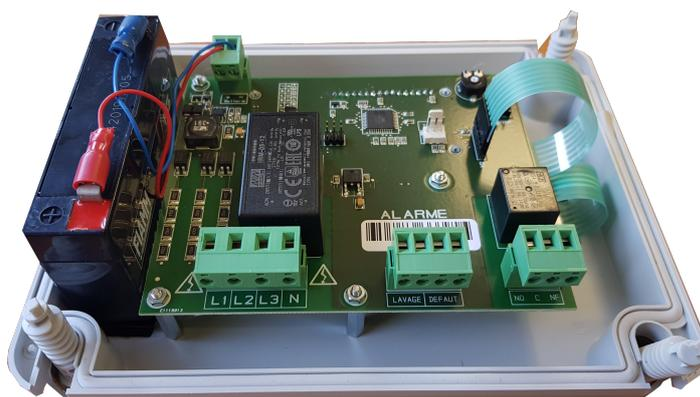
L1/L2/L3/N : Alimentation du tank en aval du disjoncteur
